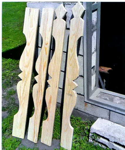
↑ Рис. 1. Элементы наличника: 1 — левая деталь; 2 — верхняя деталь; 3 — правая деталь; 4 — нижняя деталь.
