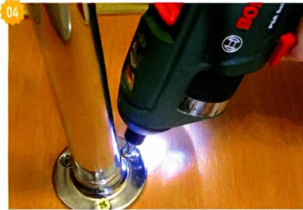
04 Все полочки, кроме верхней, держатся на фланцах, закреплённых сверху.
