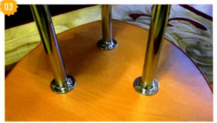
03 На основании из ЛДСП закреплены три стойки.
